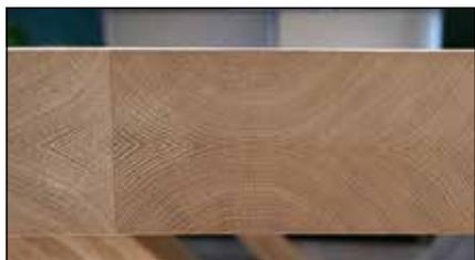
mit der selben Lamelle umgeklappt
